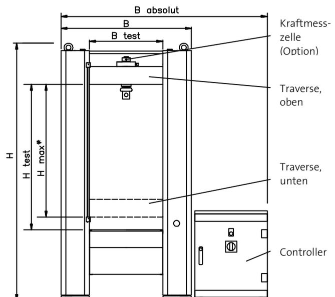
\* Prüfhub ohne Prüfwerkzeuge, Adapter und Kraftmesszelle
