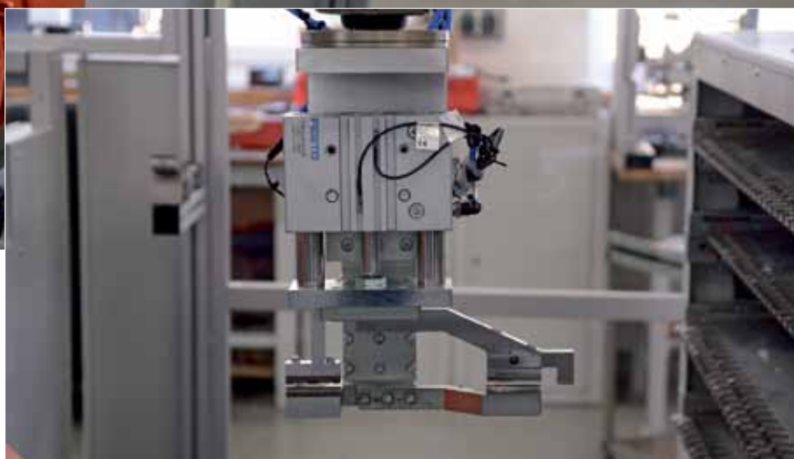
Der Pneumatikgreifer wird über Ventile von Festo angesteuert.
