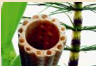
„Technischer Pflanzenhalm“: Er vereint Stabilität mit Leichtigkeit
