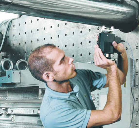
Das Dynatest Scx wurde speziell für die Messung von Guss entwickelt Bild: Ernst
