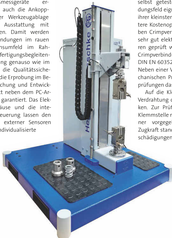
Die Universalprüfmaschine Inspekt Solo 2,5 kN in der kleinsten Bauform eignet sich für die Prüfung von kleinen Bauteilen wie etwa Crimpverbindungen. Bilder: Hegewald & Peschke
