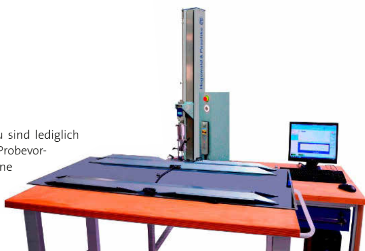
Auch für die Prüfung von Solarmodulen eignet sich die Inspekt Solo 2,5 kN
