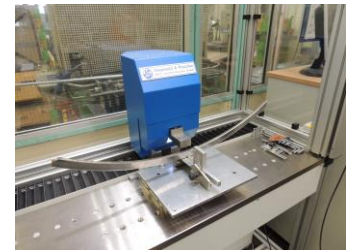
Abb.: Steifigkeitsprüfmaschine für Bürstendichtungen
