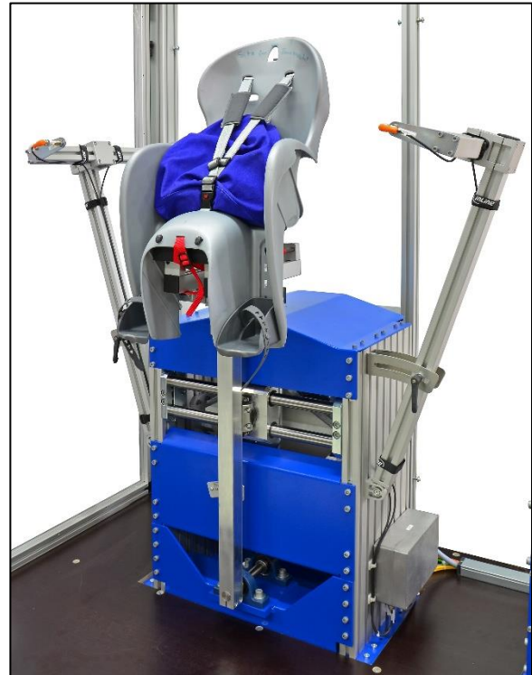
Abb. 1: Prüfeinrichtung für die Seiten- und Quersteifigkeitsprüfung
