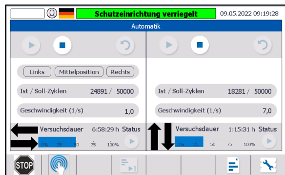
Abb. 4: Touchscreen zur Bedienung des Prüfstandes – Anzeige bei laufender Prüfung
