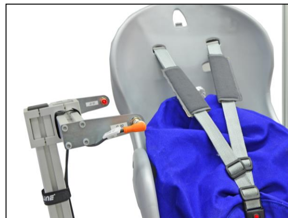
Abb. 2: Lichtschranken zur Überwachung der Auslenkung
