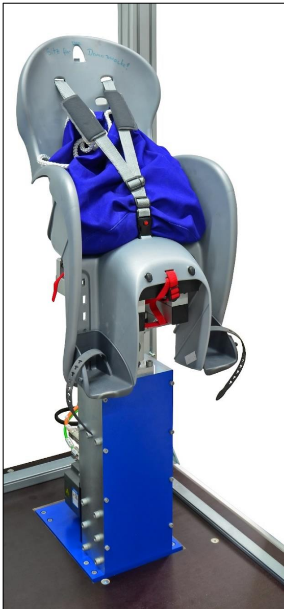
Abb. 3: Prüfeinrichtung für die Senkrechtprüfung
