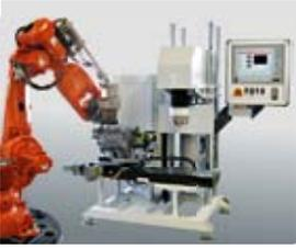
*Dieses vollautomatische Härteprüfzentrum arbeitet in einer Gießerei. Es prüft die Brinellhärte an Motorblöcken – hunderte pro Tag.*
