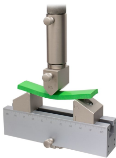
3-Punkt-Biegeversuch nach ASTM-D7264, ASTM- D6272, DIN EN ISO178
