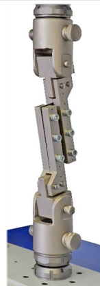
Scherzugprüfung nach ASTM-D4255 (two-rail shear)
