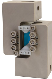
3-Punkt-Biegeversuch nach ASTM-D2344
