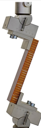
Iosipescu Versuch nach ASTM D5379
