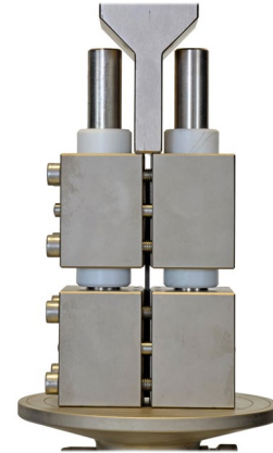
Scherzugprüfung nach ASTM C273, ISO 12090, NFT 56-605, ISO 1922-1981
