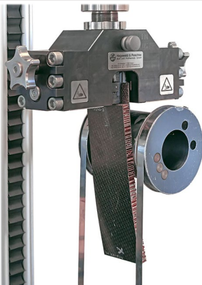
Trommelschälprüfung nach ASTM 1781, ASTM C297
