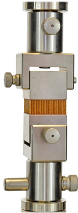
Trommelschälprüfung nach ASTM 1781, ASTM C297
