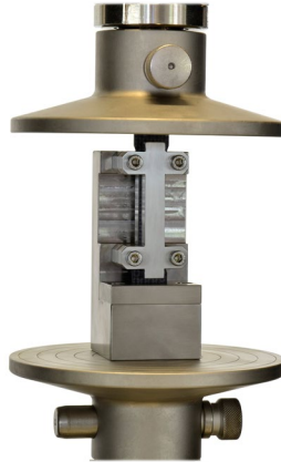
Stauchdruckprüfung nach ASTM D695, ASTM D3846, EN 2850, ISO 14126
