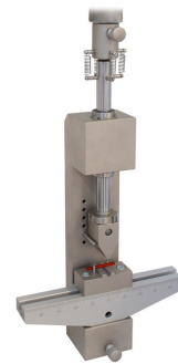
3-Punkt-Biegeversuch nach DIN EN 2563, DIN EN 2562
