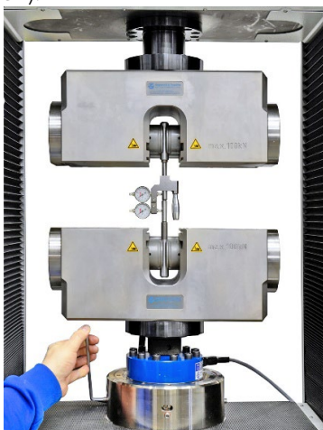
Abb.: Ausrichtadapter mit Messvorrichtung
