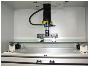
4-Punkt-Biegeversuch nach DIN EN 1288-3
