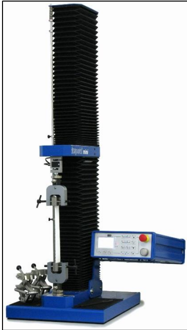
Universalprüfmaschine Inspekt mini 3kN mit Schraubspannzeug
