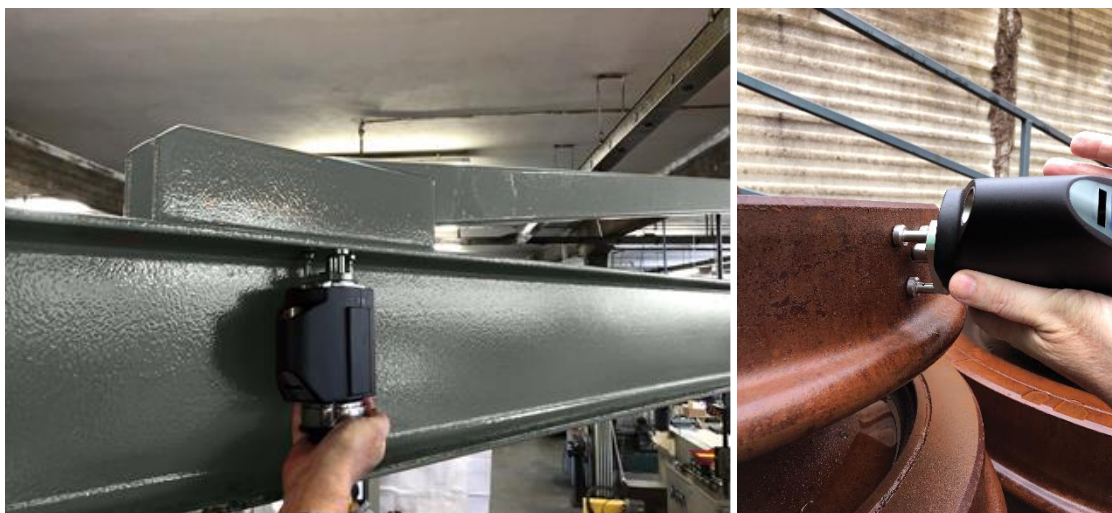
Prüfung von rauen Oberflächen und Gusswerkstoffen
