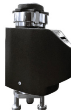
Prüfkopf mit 2 wechselbaren Eindringkörpern (Rockwelldiamant und 1/16" Hartmetallkugel)
