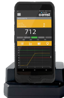
Auswerteeinheit (5,9" Tablet mit Touchdisplay) mit Ladestation
