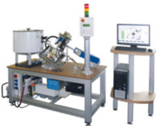
Prüfanlage für Münzrohlinge
