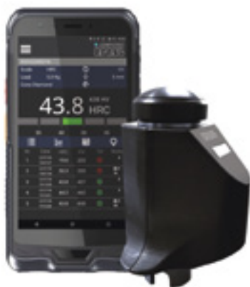
Tragbares Härteprüfgerät e-computest. Oben: mit Stativ
