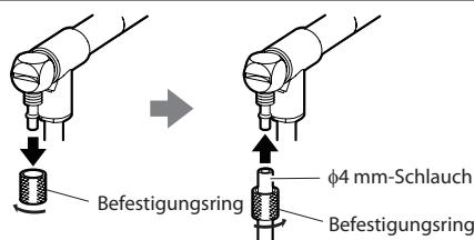
Abb. 6 Befestigen des  $\phi 4$  mm-Schlauches
