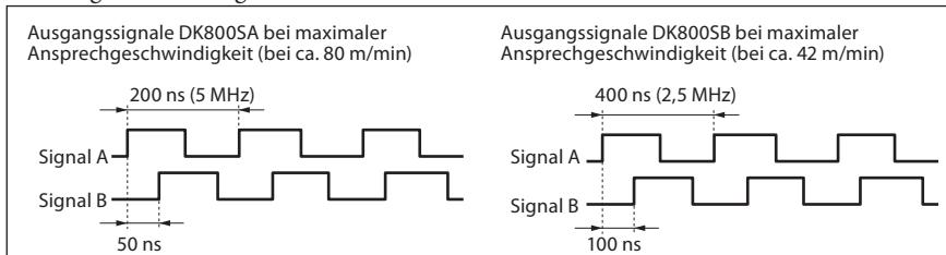
Dieser Messtaster gibt ein AB-Quadratursignal mit einer maximalen Frequenz von 5 MHz und einer minimalen Phasendifferenz von 50 ns für das Modell DK800SA und mit einer maximalen Frequenz von 2,5 MHz und einer minimalen Phasendifferenz von 100 ns für das Modell DK800SB aus. Daher ist ein Zähler oder Regler zu verwenden, der diese Signale verarbeiten kann.
