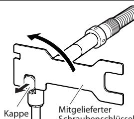
Abb. 4 Entfernen der Kappe
