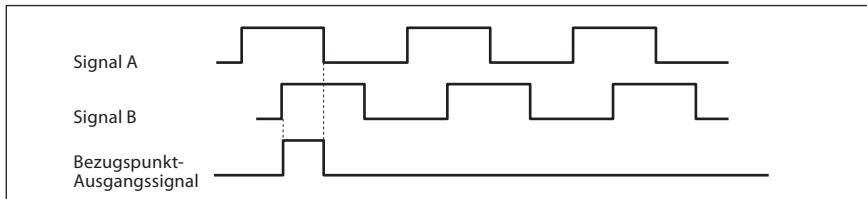
Der Bezugspunkt ist der synchronisierte Bezugspunkt, der sich auf H-Niveau befindet, wenn Signal A und Signal B sich auf H-Niveau befinden.
