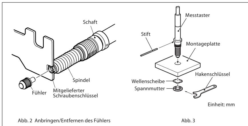
Abb. 2 Anbringen/Entfernen des Fühlers
