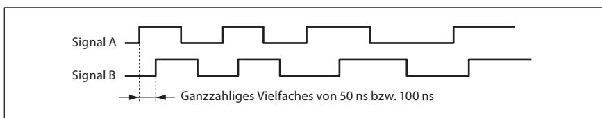
Bei Standardspezifikationen ist die minimale Phasendifferenz beim Modell DK800SA fest auf 50 ns und beim Modell DK800SB fest auf 100 ns eingestellt, doch stehen Sonderspezifikationen mit den in der nachstehenden Tabelle aufgelisteten minimalen Phasendifferenzen zur Verfügung.
