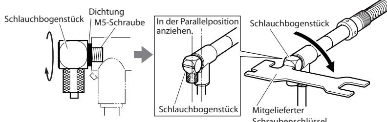
Abb. 5 Befestigen des Schlauchbogenstücks
