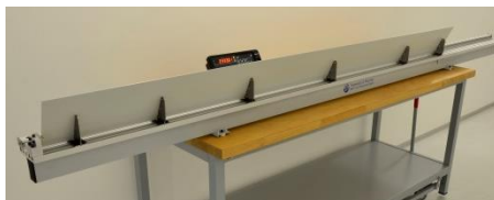
Längenmessung an Blechstreifen
