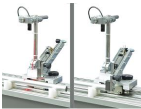
Kombi-Mobilanschlag mit Linienlaser (links: optische Messung Probenmitte / rechts: mechanisches Antasten am Probenende)
