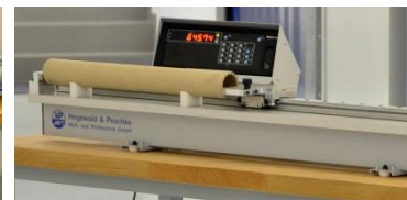
Längenmessung an Papprohren
