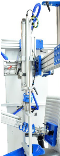
Abb. 7: Sitz-/Rückenlehnenprüfung für Wohn- und Objektmöbel im Prüffeld
