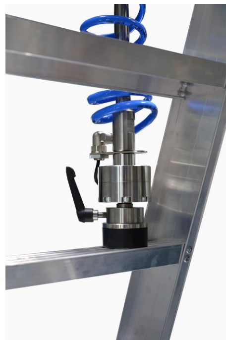
Abb. 1: Druckstempel an pneumatischer Prüfschse beim Dauerbelastungsversuch
