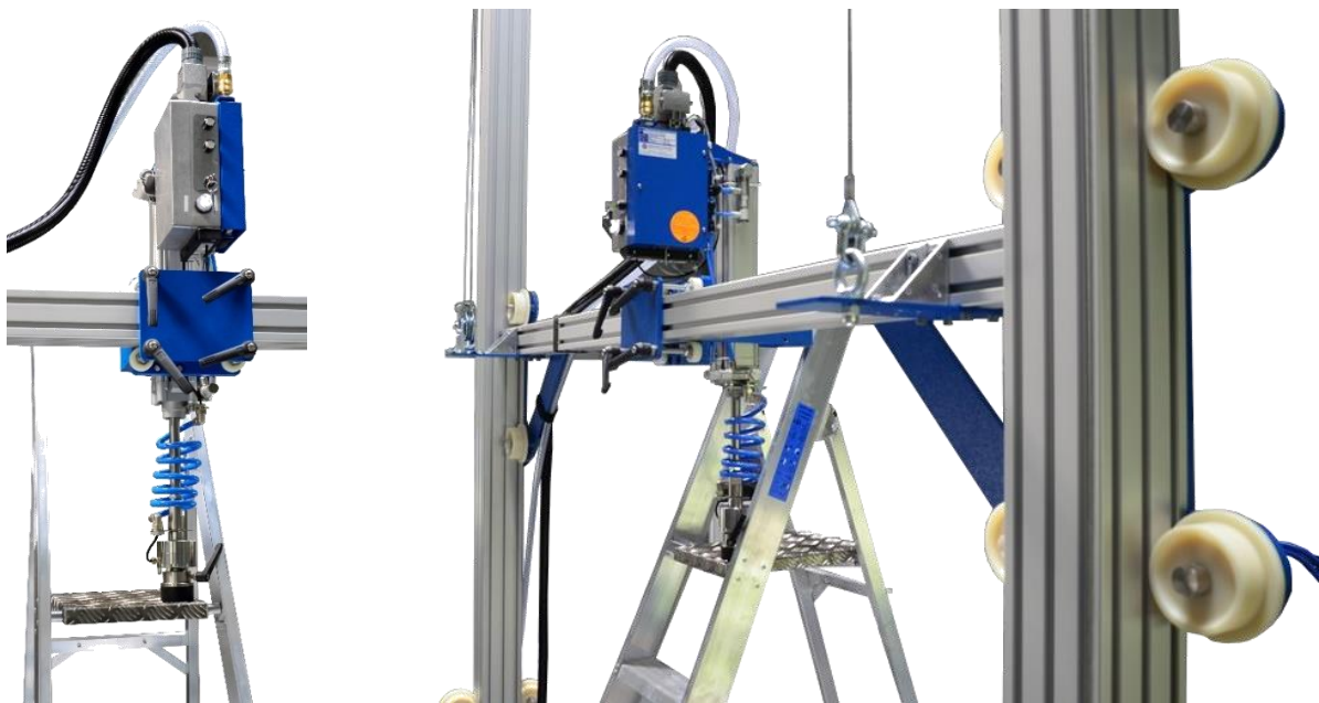
Abb. 3: Prüfzylinder, Frontalansicht (links) und Ansicht auf Querprofil (rechts)
