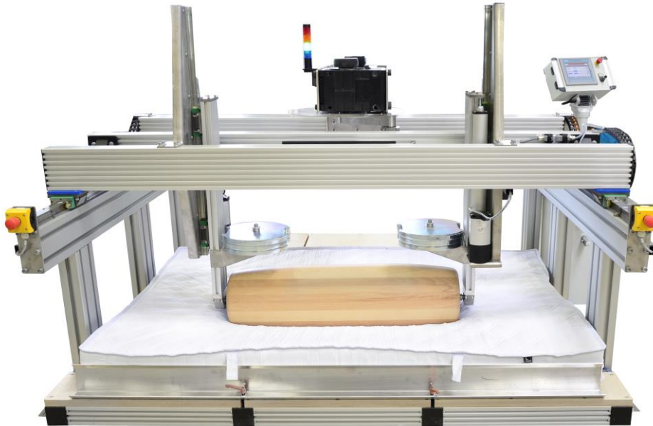
Einzelprüfstand für die Dauerhaltbarkeit von Matratzen, Federkernen und (Boxspring-)Betten nach EN 1957 (Art.-Nr.: 40-830-157)
