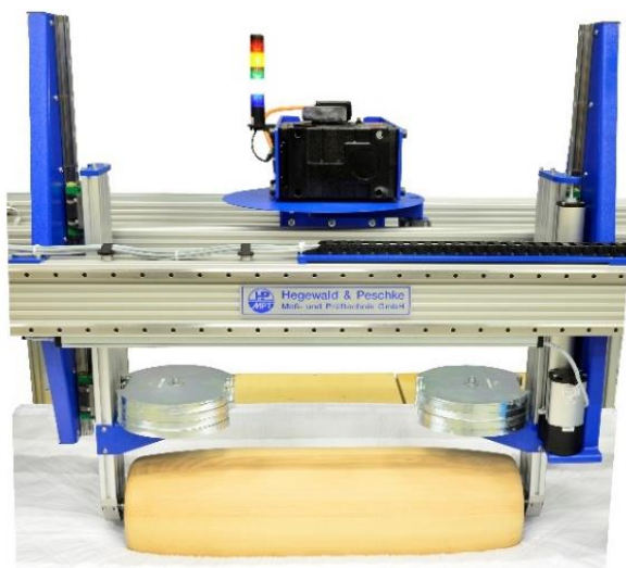
Belastungseinrichtung mit Gewichtsscheiben
