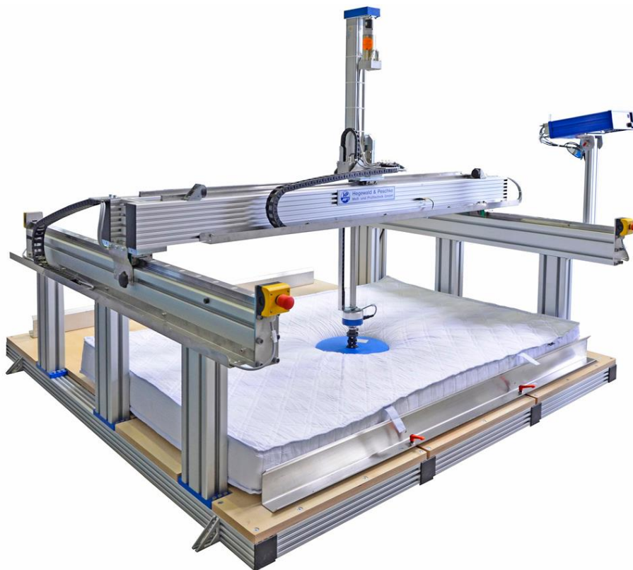
Einzelprüfstand für Härteprüfung von Matratzen, Federkernen und (Boxspring-)Betten nach EN 1957 (Art.-Nr.: 40-830-158)
