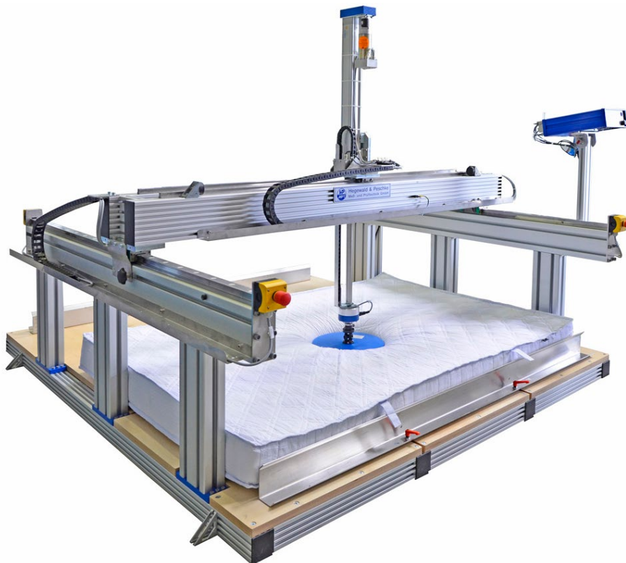
Einzelprüfstand für Härteprüfung von Matratzen, Federkernen und (Boxspring-)Betten nach EN 1957 (Art.-Nr.: 40-830-162)
