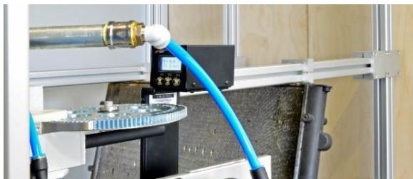
Abb. 2: Geschwindigkeitsmesser und Probenmagazin
