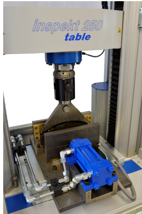
Abb. 1: Abscherversuch an einer Bremsbacke
