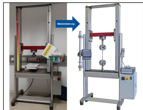
Modernisierung Kögel 207 20 kN
