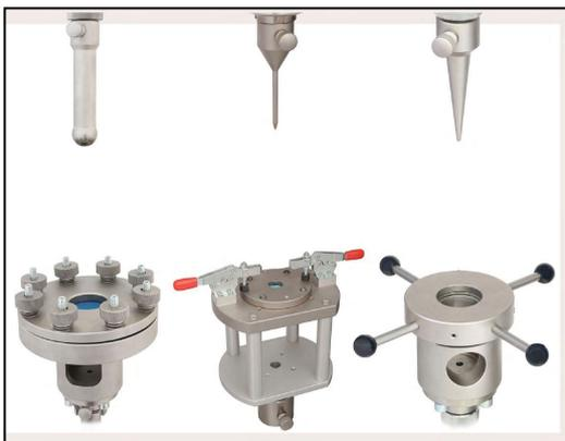
Mittels Durchstoßversuchen an Elektrodenfolien wird analysiert, wie widerstandsfähig diese gegenüber mechanischen Durchstößen sind, die
