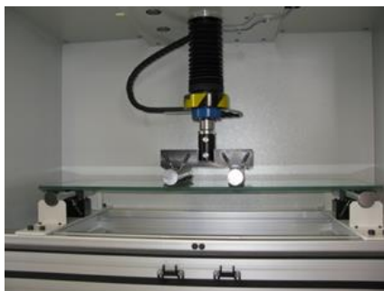
Abb. 2: 4-Punkt-Biegeversuch nach DIN EN 1288-3
