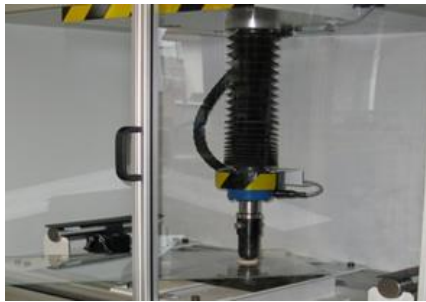
Abb. 1: Stempeldruckversuch nach ISO 614
