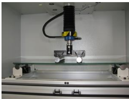
Abb. 2: 4-Punkt-Biegeversuch nach DIN EN 1288-3
