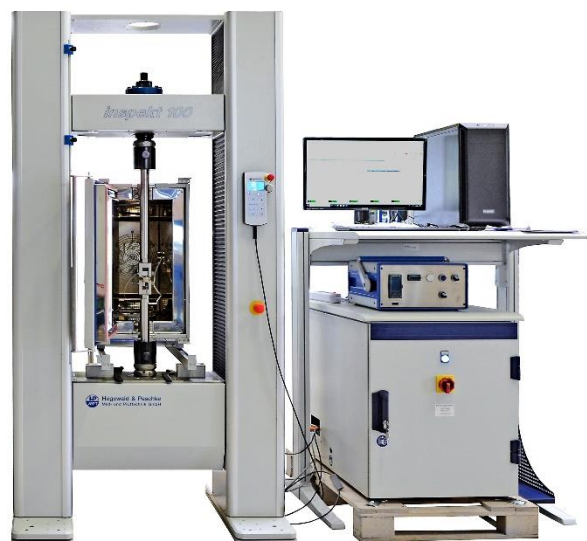
Abb. 1: Prüfsystem für Bruchmechanikuntersuchungen
