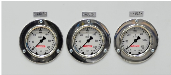
Abb. 1: Analoge Serviceanzeige für Spanndruck oben/unten und Systemdruck
