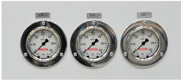
Abb. 1: Analoge Serviceanzeige für Spanndruck oben/unten und Systemdruck
