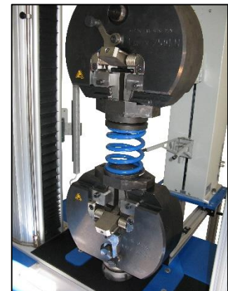
Gesamtsystem mit adaptierten Druckplatten zur Prüfung von Federn
