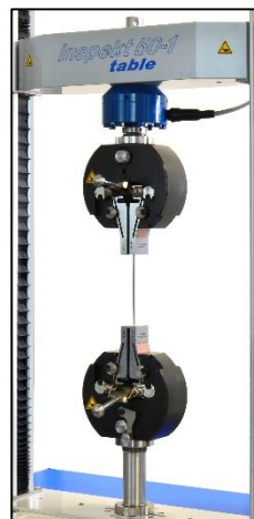
Gesamtsystem mit verlängerten Klemmbacken für die Einspannung von Drähten
