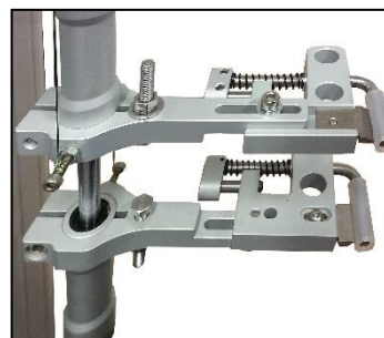
Abb. 2: Messarme des Langwegdehnungsmessgeräts L1100 / B-Typ (90° eingedreht)
