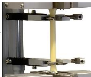
Abb. 1: Messarme des Langwegdehnungsmessgeräts L1100 an einer Kunststoffprobe C-Typ (Standard)
