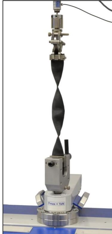
Torsionsprüfung an Twist-Öffnungen von Tampons
