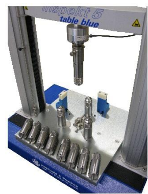
3-Punkt-Miniaturbiegevorrichtung für GFK/CFK Proben nach DIN EN 2563
