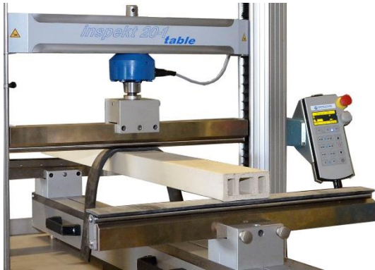
3-Punkt-Biegeprüfung an Holzlatten und Dämmstoffen nach EN 12089
