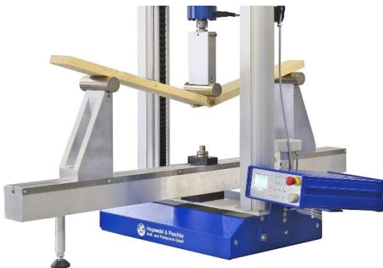
4-Punkt-Biegeprüfung an Glas nach ISO 614 und DIN EN 1288-3
