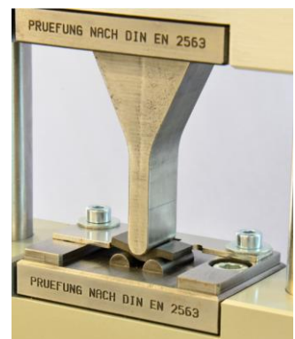
3-Punkt-Miniaturbiegevorrichtung für GFK/CFK Proben nach DIN EN 2563
