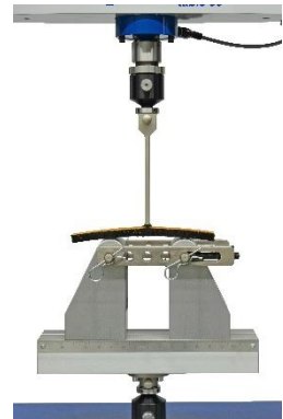
Biegevorrichtung „Ball on 3 Balls“ für biaxiale Biegeversuche an Wafern
