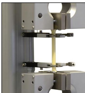
Abb. 1: Messarme des Langwegdehnungsmessgeräts L1100 an einer Kunststoffprobe C-Typ (Standard)
