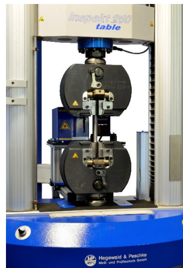
Abb. 5: Einsatz P-50 mit Universalprüfmaschine inspekt table 250kN für Metallzugversuch
