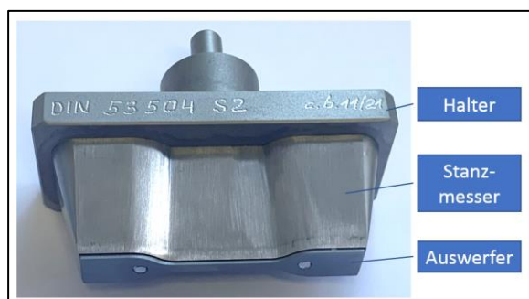
Abb. 1: Aufbau Stanzmesser aus vollem Stahl erodiert
