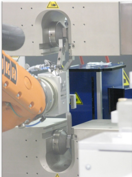
Abb. 4: Einsatz des SWS-300 in automatisiertem Prüfsystem für Metallzugversuche
