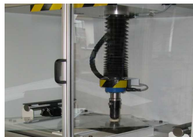
Stempeldruckversuch nach ISO 614
