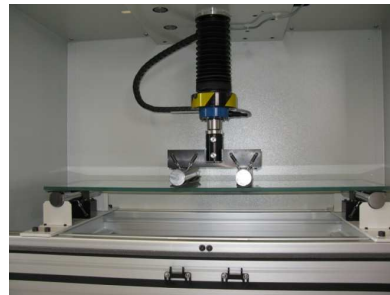
4 Punkt-Biegeversuch nach DIN EN 1288-3
