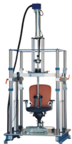
Falltestprüfstand zur Prüfung von Tischen, Sitzmöbeln und Polstermöbeln
