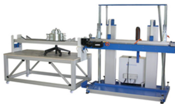
Elektromotorisches Linearmodul zur Prüfung von Möbelrollen und Wohnmöbeln
