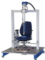
Drehprüfstand zur Prüfung von Möbelrollen und Drehgelenken
